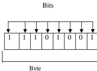
Fig. 3.4 Bits and Bytes
